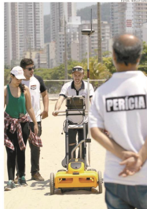
O equipamento funciona como uma espécie de radar subterrâneo
